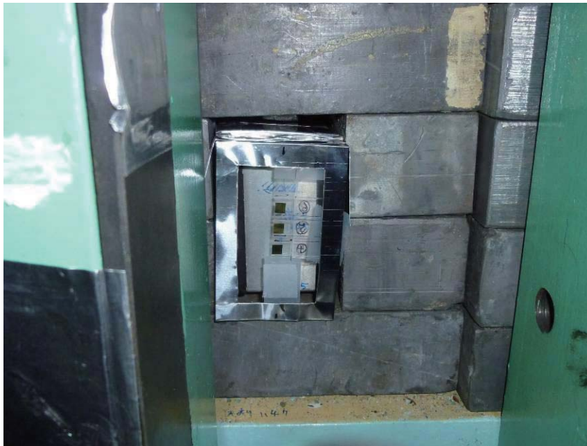
第 4.2.5 図 C3-2 ビームポート測定位置に設置した金箱(ポリエチレン内に置かれている)
