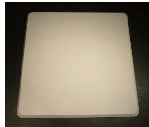
リチウムフィルタ 寸法: 208 × 208 × 5 mm
