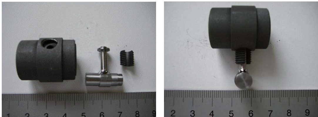
第 4.5.3 図 改良した標的槽の写真
