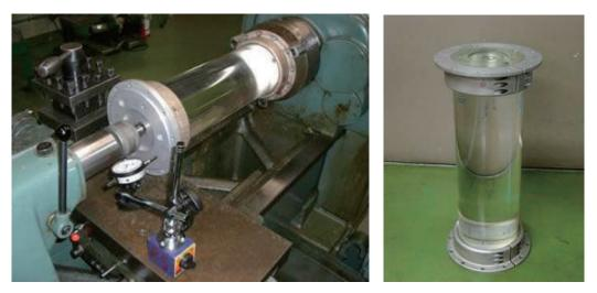
第3.4.1 図 アクリルシャフトフランジ面の傾き調整作業の様子と取り外したアクリルシャフト の写真
