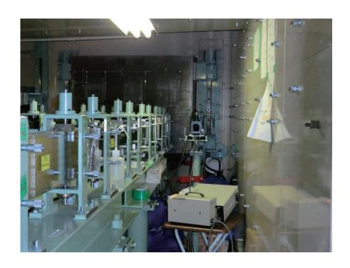
第5.2.4 図 新規製作した高性能中性子鏡管ユニットの据付(炉室内導管室)
