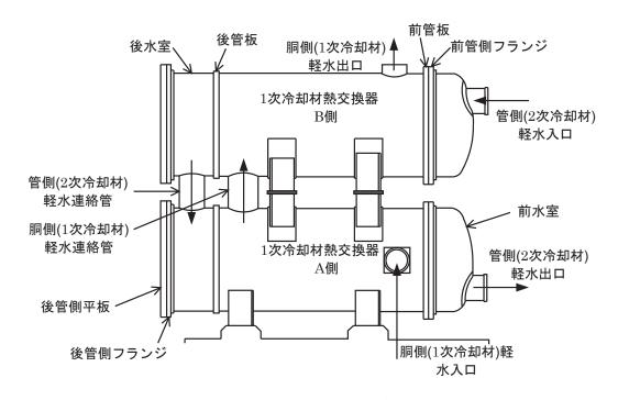
第3.1.2図 1次冷却材熱交換器概略図
