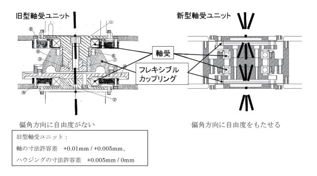
第3.6.11図 旧型軸受ユニットと新型軸受けユニットの概略図
