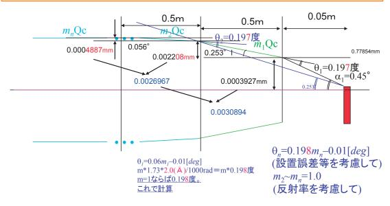
第5.1.7図 テーパー型小型中性子導管試験体の設計
