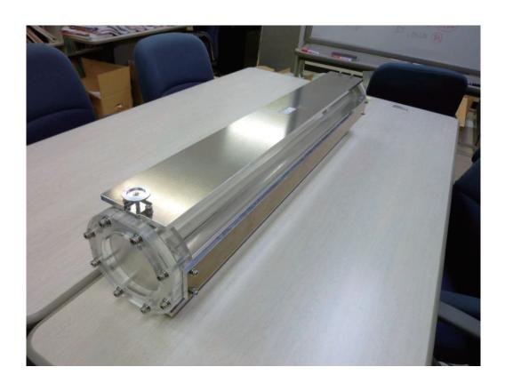
第5.1.11 図 製作したテーパー型小型中性子導管試験体特性測定用真空チャンバー付き架台
