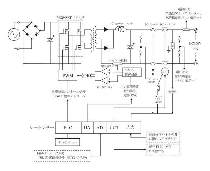
第3.6.10図 スイッチング方式試作概要図 ※保持用コイル電源のみ(制御用コイルも構造は同様)
