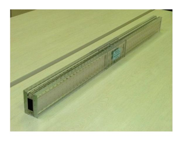
第5.1.9 図 製作したテーパー型小型中性子導管試験体
