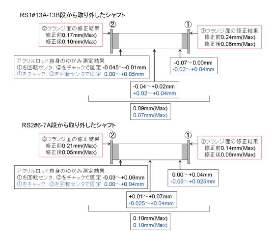
第3.4.2 図 アクリルシャフトフランジ面の傾き調整の結果
