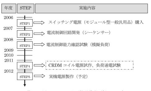
第3.6.1 図 CRDM コイル電源制御盤更新ステップ
