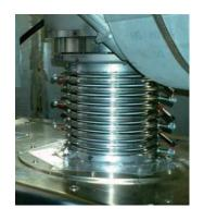
第 2.4.8 図 9 ギャップ 加速管(BM EC-1 上部)
