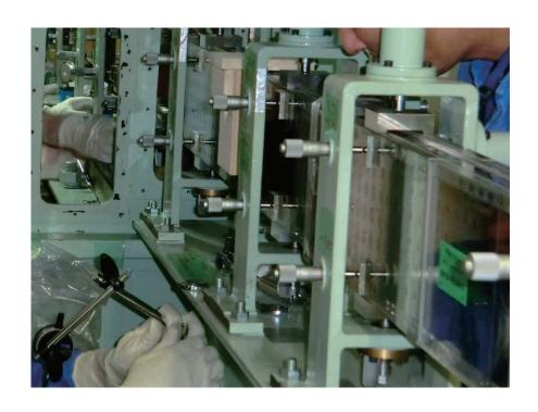
第5.2.3 図 新規製作した高性能中性子鏡管ユニット(C3 冷中性子導管)
