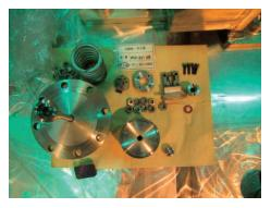
第3.1.1図 サイフォンブレーク弁の 部品手入れ
