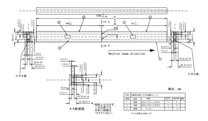
第5.1.8 図 テーパー型小型中性子導管試験体の参考図
