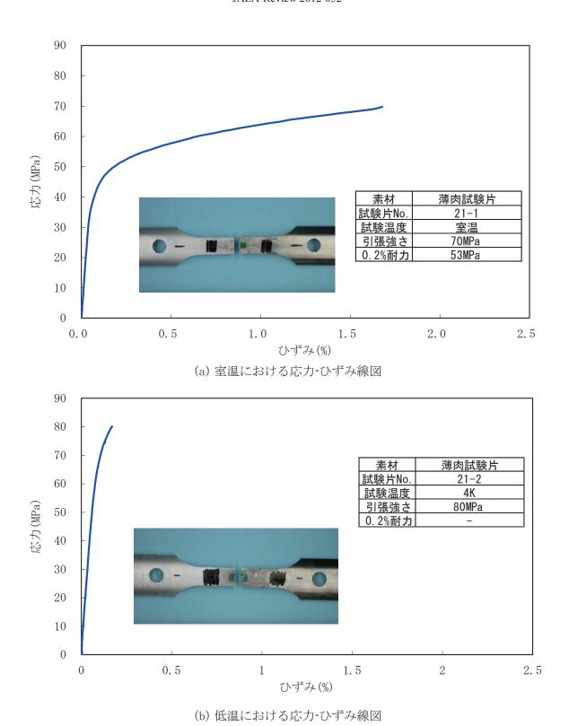
第5.1.3 図 引張強度確認試験の結果
