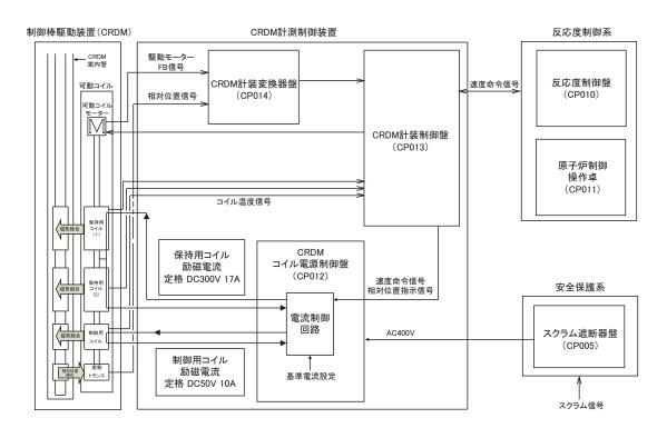
第3.6.2 図 CRDM コイル電源制御盤概要図
