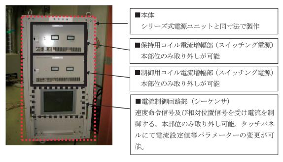
第3.6.9 図 試作電源ユニット写真(1ユニット拡大写真)
