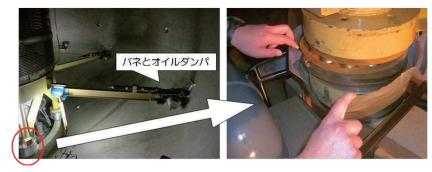
第 2.4.6 図 タンデム加速器の免震機構。絶縁カラムはベアリング の上に設置されバネとオイルダンパーを備えた横からの支柱で揺 れを抑える。右写真は地震により中心からずれたベアリング。
