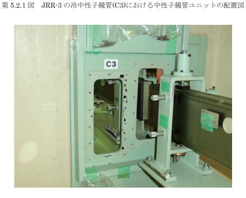
第5.2.2 図 既設中性子鏡管ユニット(C3冷中性子導管)
