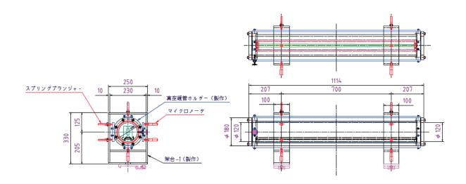
第5.1.10 図 テーパー型小型中性子導管試験体特性測定用真空チャンバー付き架台の参考図
