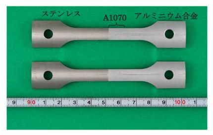
第5.1.1 図 引張強度試験用試験片の外観
