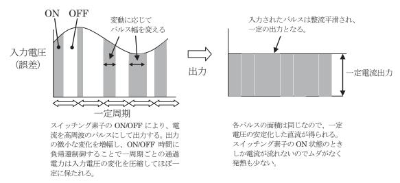
第3.6.7 図 スイッチング式電源 (PWM 方式) 出力イメージ
