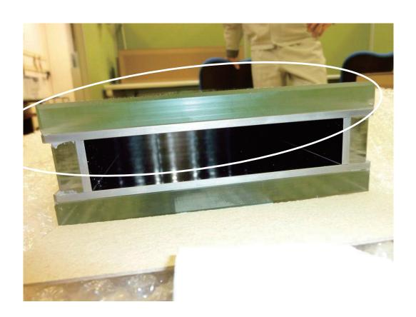
第 5.2.6 図 成膜した薄いガラスを厚いガラスで支えるサンドイッチ構造を持つ、新規製作した 高性能中性子鏡管ユニット
