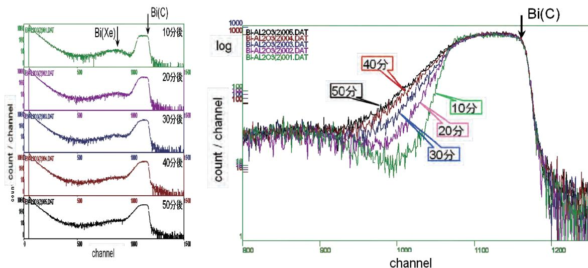
図 4.5.7 デュアルビームによる重イオン照射効果のリアルタイム測定結果
