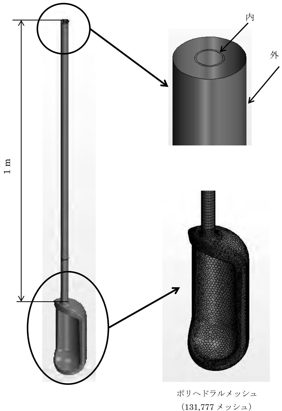
図 4.1.1 高性能減速材容器のモデル図
