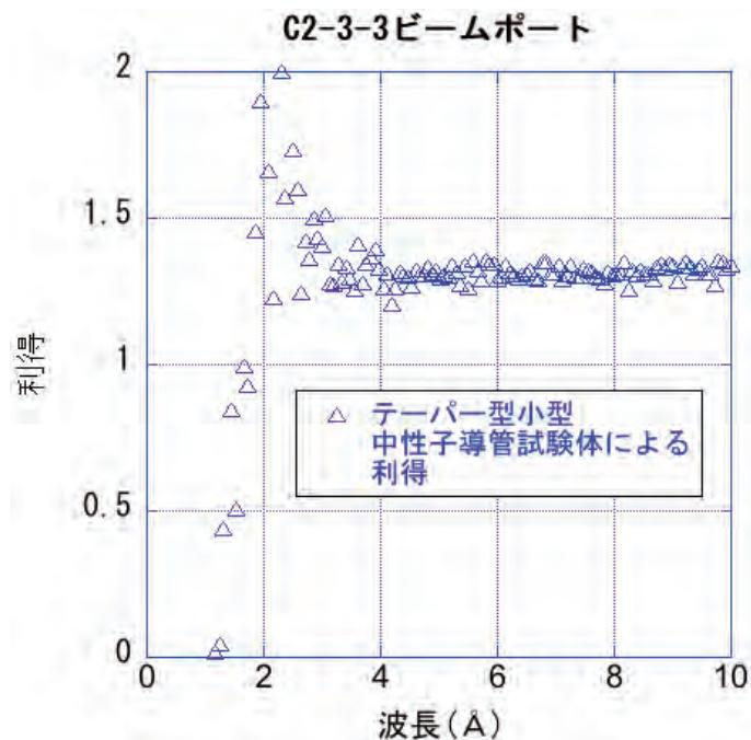
図 4.1.5 テーパー型小型中性子導管試験体を設置した場合と設置しない場合の計算結果から
