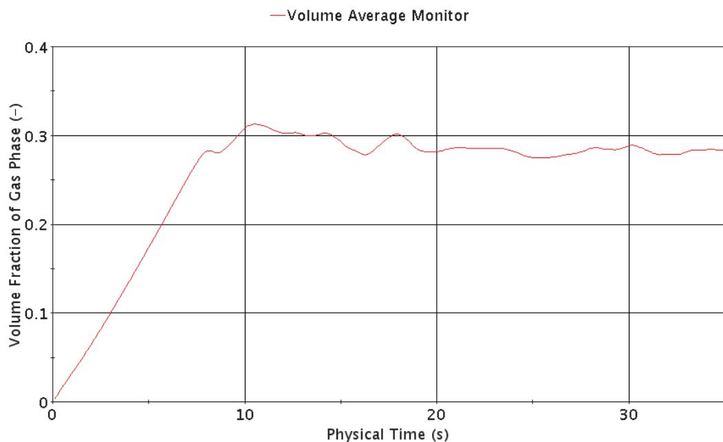
図 4.1.2 高性能減速材容器内の水素ガスの平均体積分率
