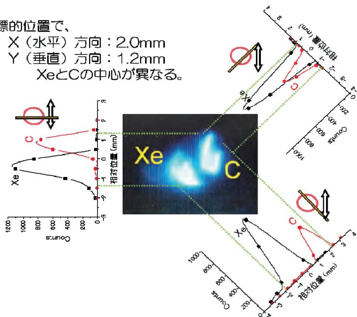
図 4.5.4 標的位置での  $^{12}\text{C}$  と  $^{132}\text{Xe}$  ビームのプロファイル
