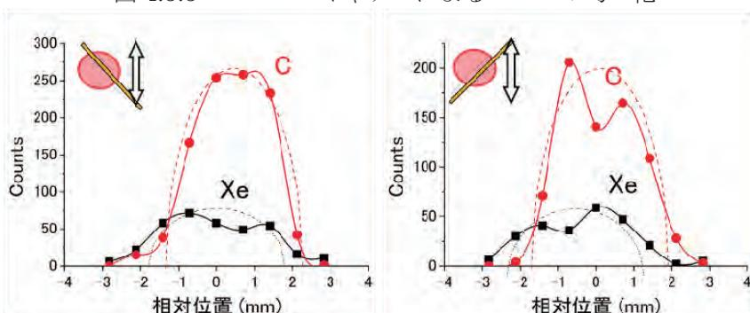
図 4.5.6 スキャナーによる均一化後のビームプロファイル
