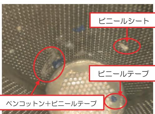
図 2.1.1 コシ筒内部の捕集付着状況
