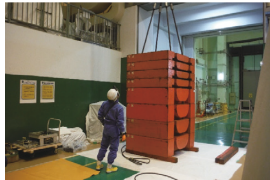
写真 3.1.2.8 試験用ウエイト(30ton)による動作試験
