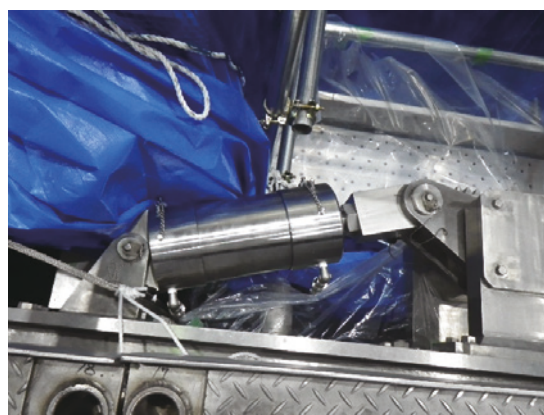
写真 3.1.2.2 駆動用水圧シリンダ 更新後 (今橋 正樹)
