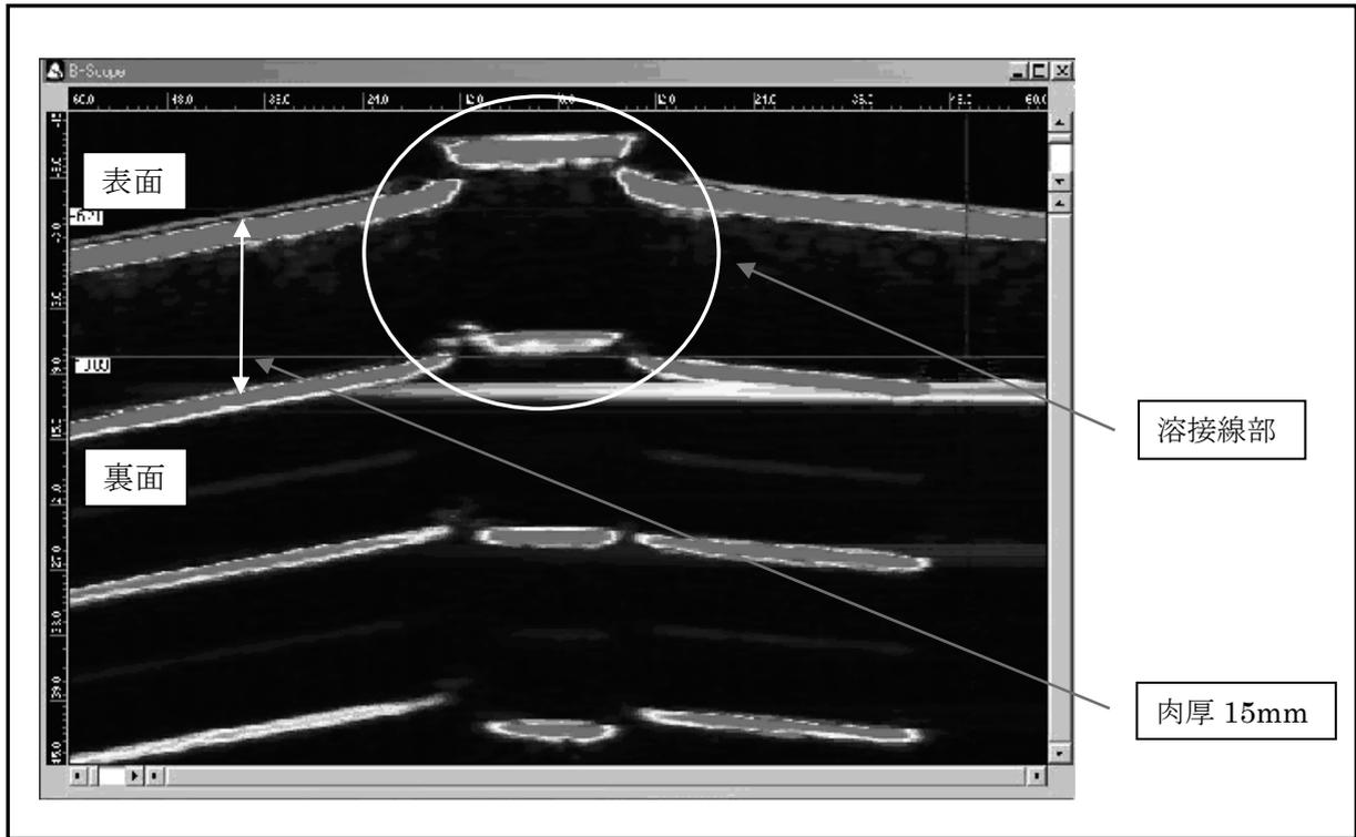
第 2.5.23 図 溶接線部の測定結果の代表例
